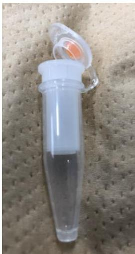
図 5-1 精密ろ過フィルター付きチューブ
