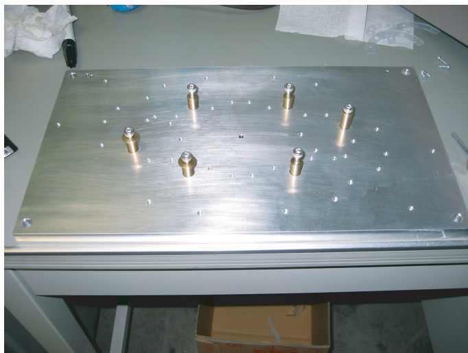
図 4.3: ベースプレートとセクターのノックピン (回転軸)
