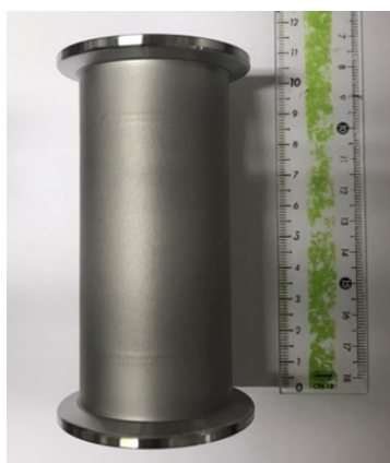
図 3.8：使用した外径 42.7 mm、長さ 100 mm の NW 40 ニップル真空配管継手の写真
