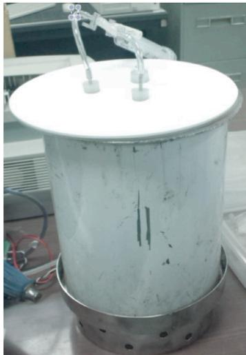
図 1.2: ガス捕集用チャンバーの写真
