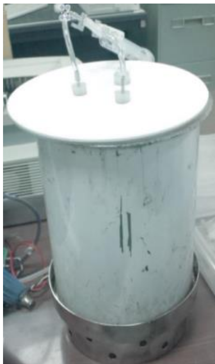
図 1.3 ガス捕集用チャンバーの写真。円筒状のチャンバーを土壌表面に被せ、地中から発生するガスをサンプリングバッグに捕集する。
